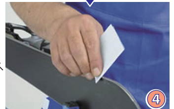
④ トップやテールのエッジが鋭く立ちすぎている場合、雪質によってはスキーが雪面に引っかかって思うようにターンできないこともあります。サンドペーパー#320か#400あるいは<サンディンググラバー>で内側から外側に向かって軽くダリングして下さい。 ※丸めすぎないようにして下さい。
