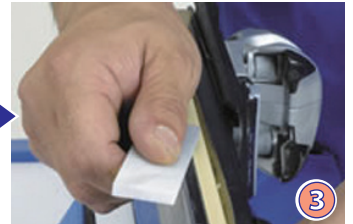
③ サイドエッジ全体を水砥石アルカンサスで最終仕上げをします。アルカンサスはそのままか、あるいは水をつけて使用してください。オイルは使用しないこと。アルカンサス本体の汚れは支障ありません。
