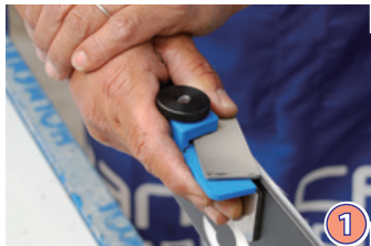
① クロスファイルで粗削りします。 ※ファイリングの際はガイド部分を滑走面におしあてて、ずれないようにして下さい。
