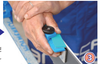
③ 雪質に応じてダイヤモンドファイルで仕上げます。
