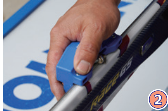
② サイドウォールプランナーでボーダーを削り取ります。※深く削り過ぎないように徐々に削っていきます。ボーダー (エッジの上の出っ張り) を削ります。
