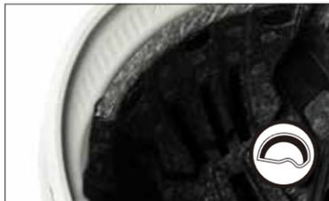
丈夫なポリカーボネイト素材のアウトシェルと衝撃吸収性に優れたフォーム状のHI-EPS素材を高温・高圧で圧着させるインモールド製法により、『強度』と『軽量化』を実現。
