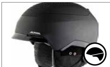
ハイブリッドテクノロジーは、インモールドとハードシェルの利点を兼ね備えています。ヘルメット上部は丈夫なハードシェル、下部は軽量のインモールドで構成され、構造上、換気システムに優れます。
