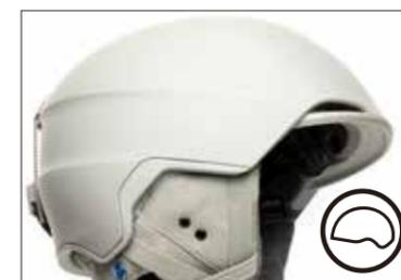
インモールド製のALPINAヘルメットには抗キズ・耐衝撃ポリカーボネイト製シェルが使用されています。シート状のシェル素材を、ヘルメット型に高圧でくり抜き、HI-EPS本体に圧着します。
